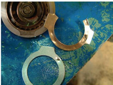
► Рис. 2. Повреждение всасывающего клапана в результате гидроудара
