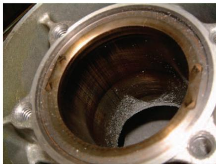
► Рис. 3. Следы разложения масла на стенках цилиндра из-за перегрева компрессора
